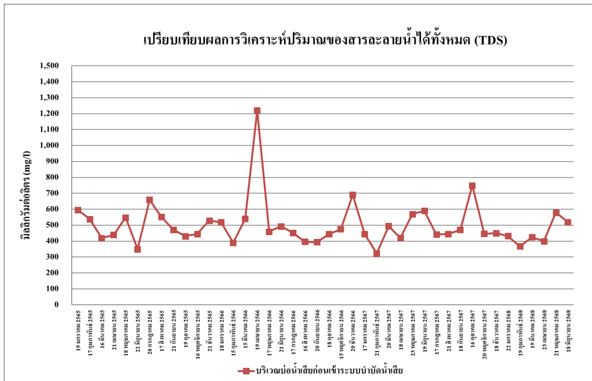
รูปที่ 4.4-28 เปรียบเทียบผลการวิเคราะห์ปริมาณสารที่ละลายน้ำได้ทั้งหมด (TDS) บริเวณบ่อน้ำเสียก่อนเข้าระบบบำบัดน้ำเสีย ระหว่างเดือนมกราคม 2565-มิถุนายน 2568
